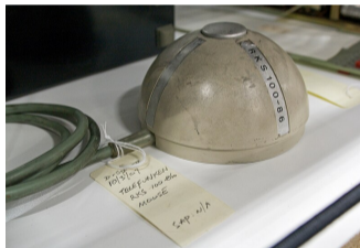
Figura 32: Primeiro Mouse com rollerball interna (1968).
